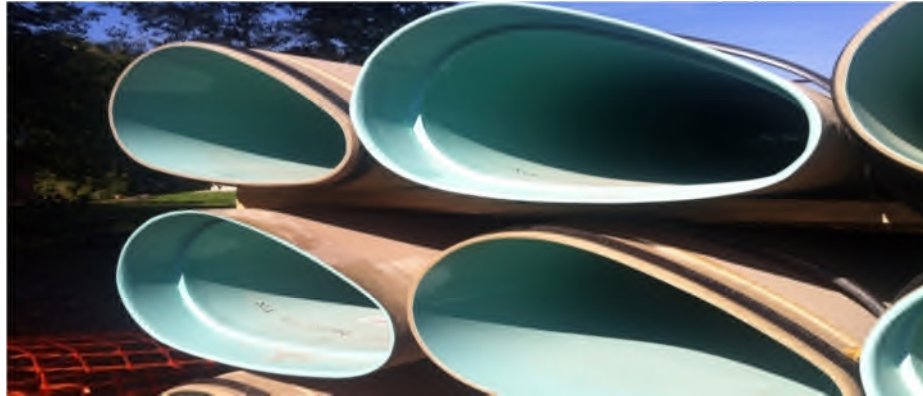
Figure I.14 : Les conduites ovoïdes [15].
