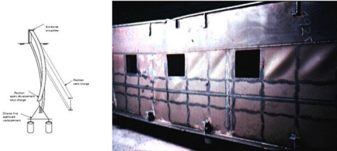
Figure I. 10: Phénomène de déversement des poutres[6].
