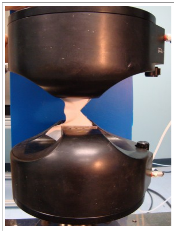
Figure 2. 7 Principe du test de déchirure
