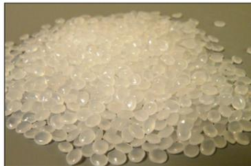
Figure 2.1 Granules de polyéthylène linéaire basse densité FPS 117-D de Nova Chemicals
