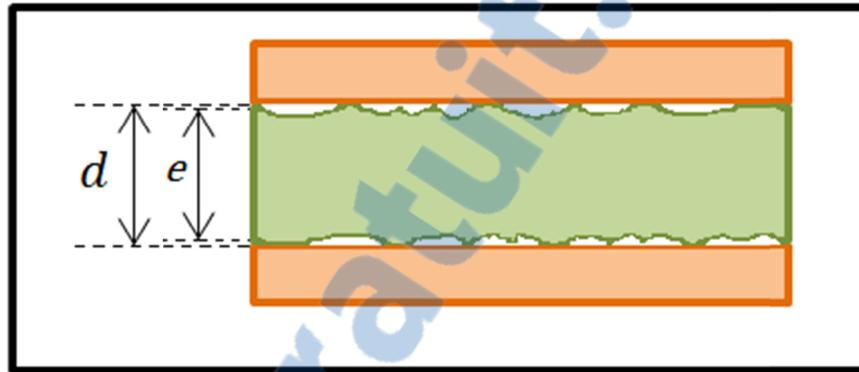
Figure 3.5 Représentation schématique de la non-planéité des échantillons
