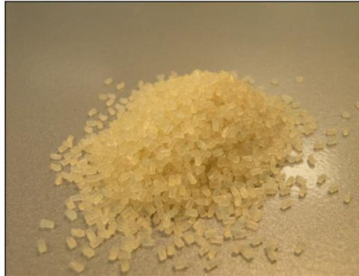
Figure 2.4 Pastilles de nanocomposites à la sortie de l'extrudeuse
