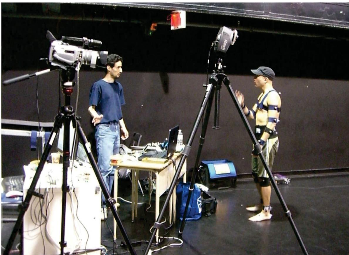
Figure 4.3 Caméra témoin et caméras de capture de mouvement
