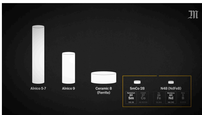
Figure 2 : Comparaison des aimants et aimants permanents (encadré orange)
