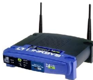
Figure I.2 : Exemple de point d'accès
