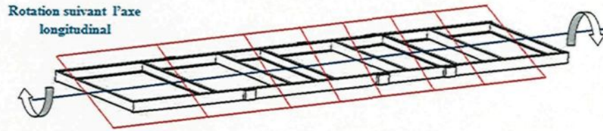
Figure 4.1 : Mouvement du roulis.
