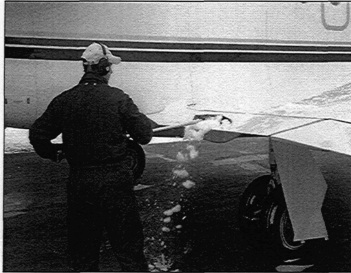
Figure 5 : Dégivrage d'une aile d'avion avec un racloir (moyen mécanique)
