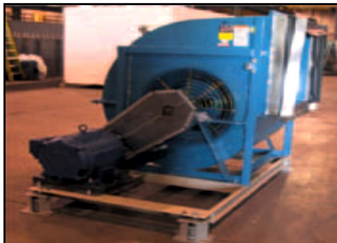
Figure 06 : Ventilateur d'alimentation de type centrifuge (Guide de qualité de l'air intérieur dans les établissements du réseau de la santé et des services sociaux, Québec) 2011
