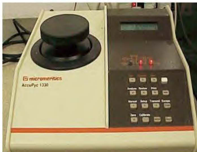
Figure 3–3 Pycnomètre à hélium AccuPyc 1330 de Micromeritics®
