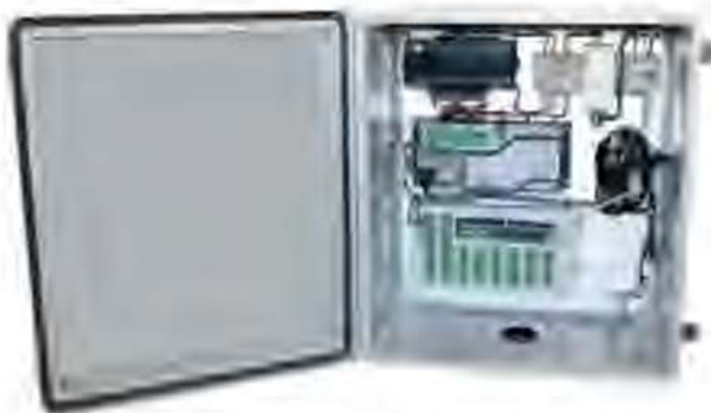
Figure 3-14 Système d'acquisition des données datalogger modèle SENSLOG (tiré de Roctest)
