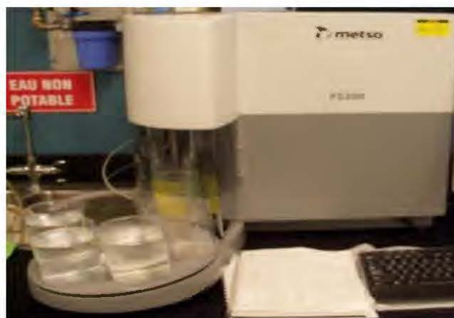
Figure 2.13 Analyseur de la qualité des fibres Metso FS300
