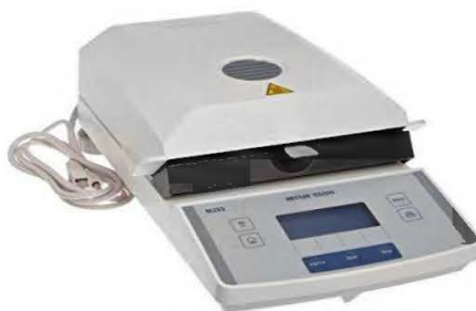
Figure 2.3 HB43-S Analyseur d'humidité à halogène pour évaluer l'humidité des matières premières
