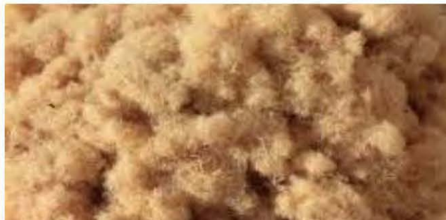
Figure 2.1 Les fibres TMP utilisées pour le procédé sec de fabrication des panneaux
