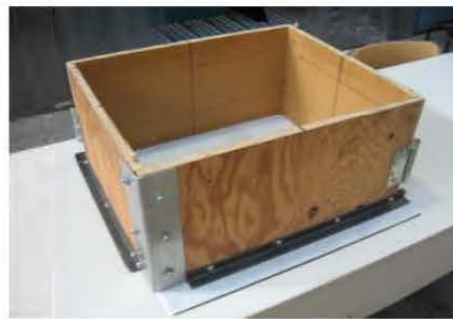
Figure 2.6 Le moule utilisé pour la préparation des ébauches
