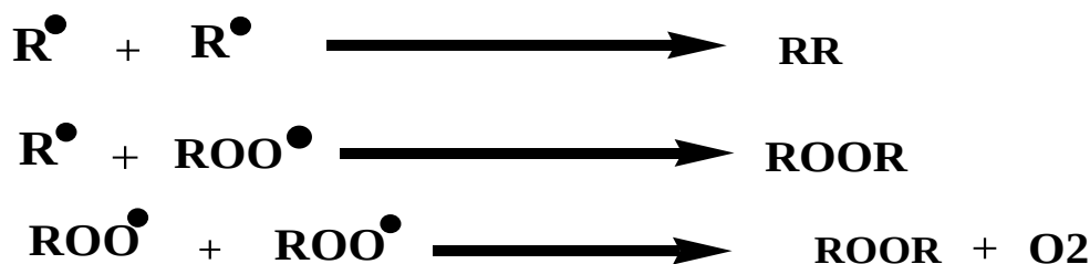
Figure 7 : phase de terminaison
