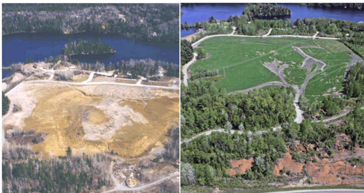
Fig. 3.13 - Carrière avant et après réaménagement [19]
