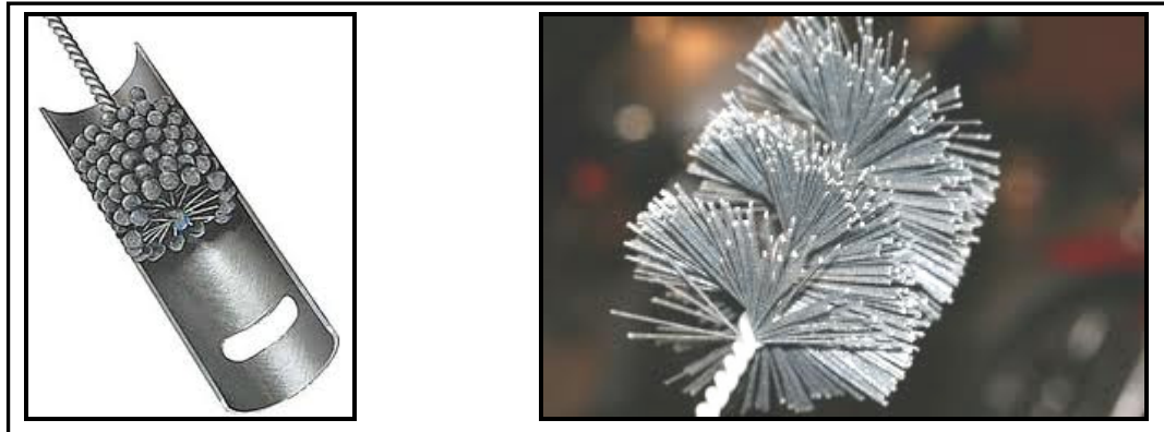
Figure 4.19 Exemple de brosse de rodage (gauche) et de brosse à tube en nylon (droite)
