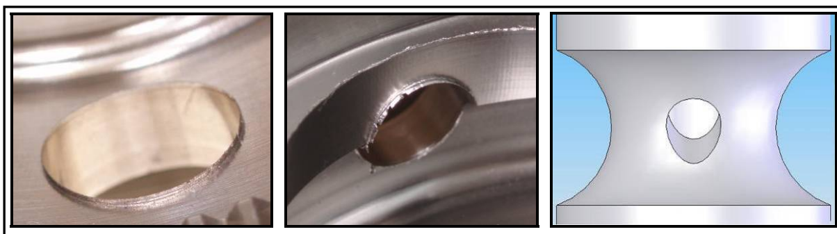
Figure 4.5 Configurations des trous (1) à travers un cylindre, (2) à travers des surfaces multiples et (3) à travers des surfaces complexes
