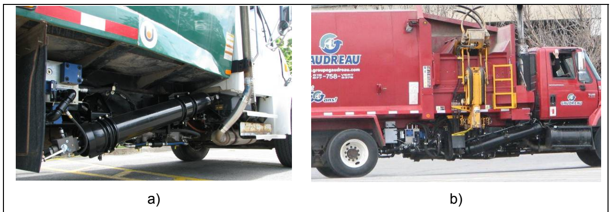
Figure 5.1 Prototypes du système hybride à assistance au MCI a) prototype P1.1 installé sur un camion à chargement arrière b) prototype P1.2 installé sur un camion à chargement latéral automatisé
