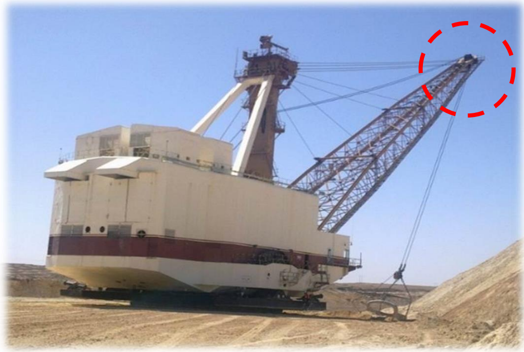
Figure 25 : positionnement du Pad-lock dans La dragline 8400M
