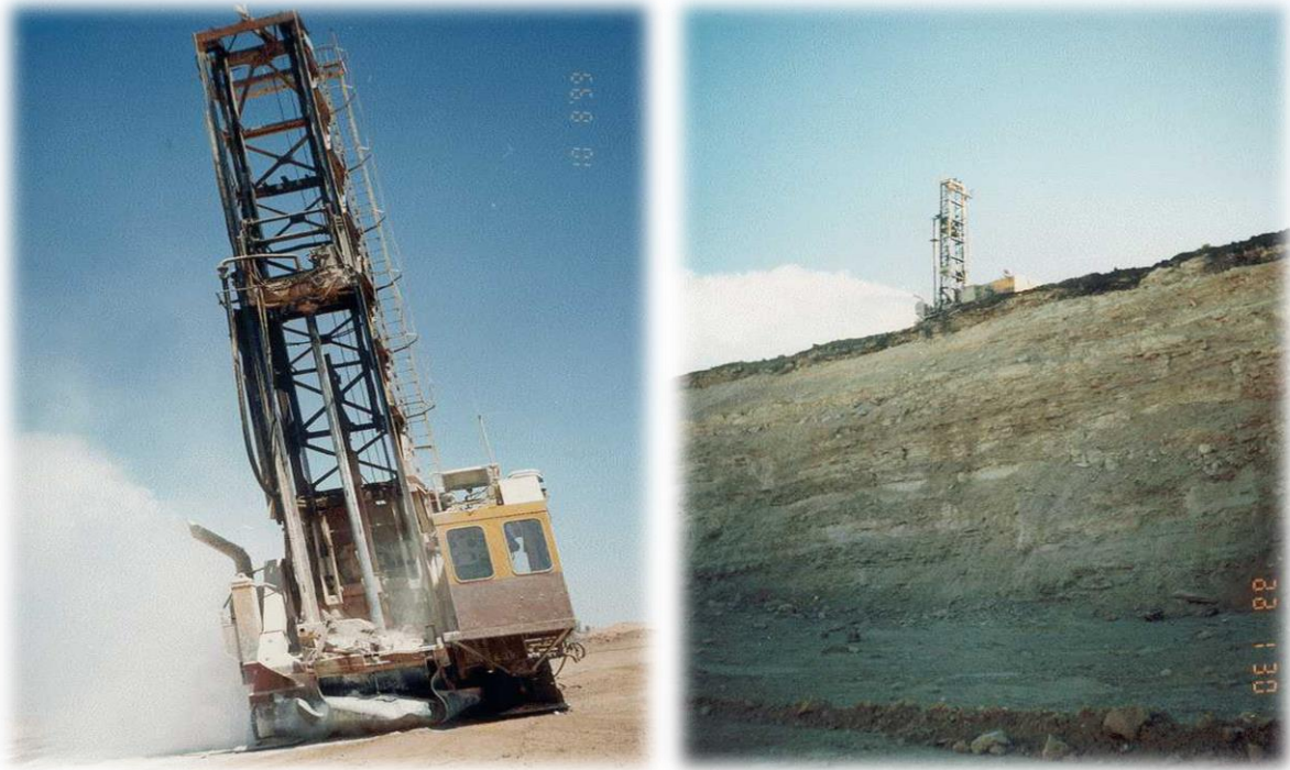
Figure 5 : la foration des trous à l'aide de la machine SONDEUSE BUCYRUS 50R.
