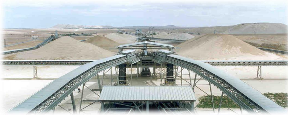
Figure 11 : Convoyeurs et transporteurs des phosphates épierrés.
