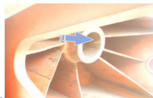
Figure 28 : position des fissures au niveau du fourreau
