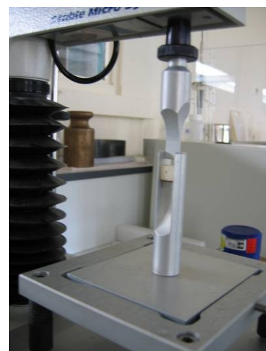
Figure 40 : Texturomètre TAXT2 équipé de la cellule de Volodkevitch
