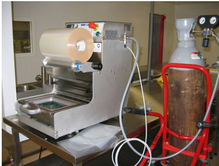
Figure 18 : Barquetteuse Mini OVG 6 et bouteille de gaz B13
