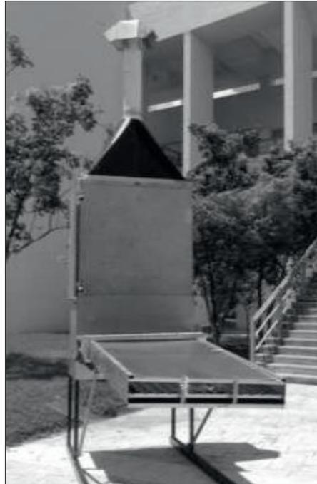
**Figure I. 25 :** Prototypes de séchoirs solaires pour le séchage de la vanille.
