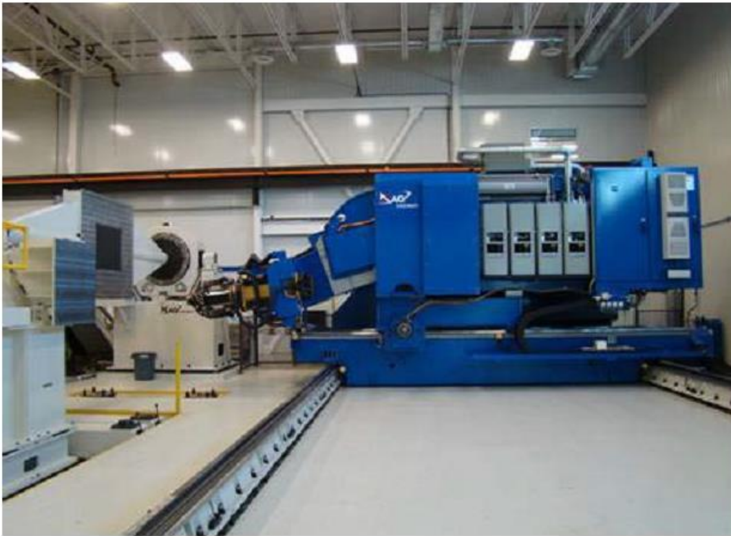
Figure 2.14 : Machine de placement automatisé des fibres (AFP).
