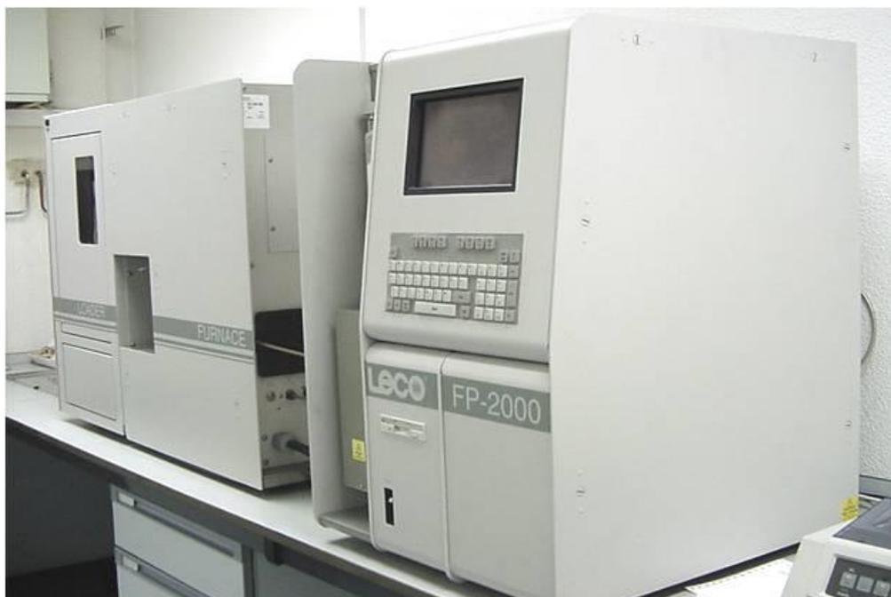
**Figure 27** : Analyseur d'azote LECO FP-2000 utilisé
