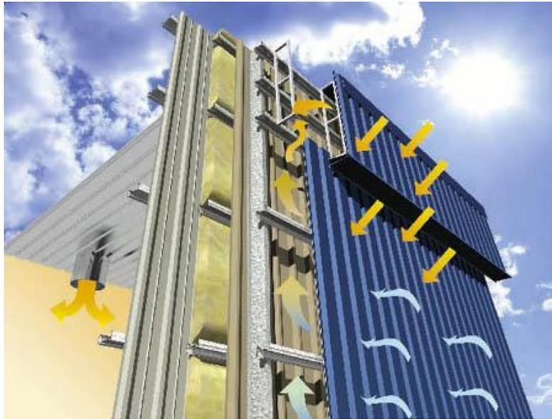
**Figure 2.2 :** Illustration du SolarWall [9]
