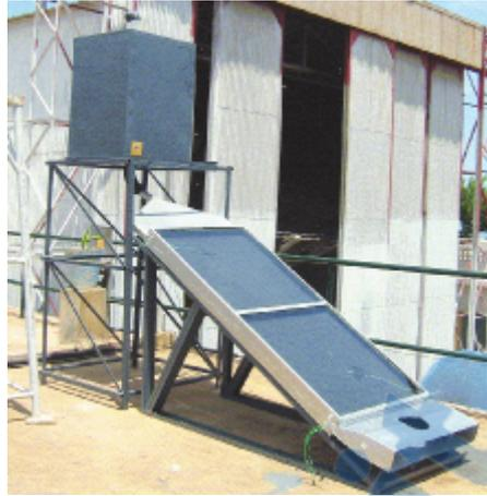
**Figure 1.8** Séchoir solaire indirect destiné au séchage des PAM, réalisé au CDER [7]
