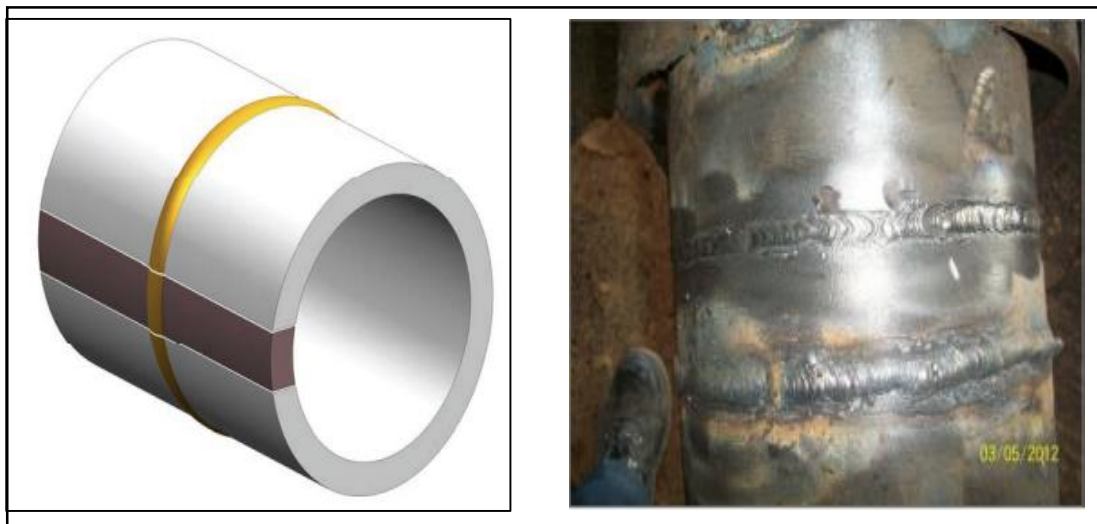
Figure 2.2: Echantillon avec soudure [11].
