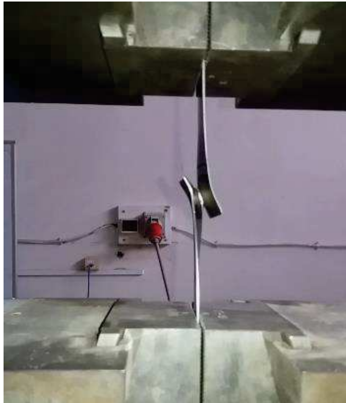
Figure II.11 : Eprouvettes rompue après essai de cisaillement par traction.
