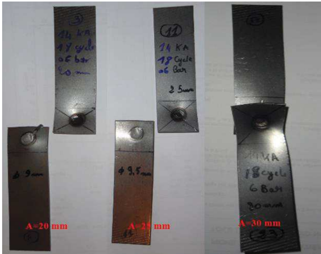
Figure III.33 : Eprouvettes rompues après l’essai de traction pour T=18 Cycle, F=6 Bars et I=14KA Avec différent recouvrement
