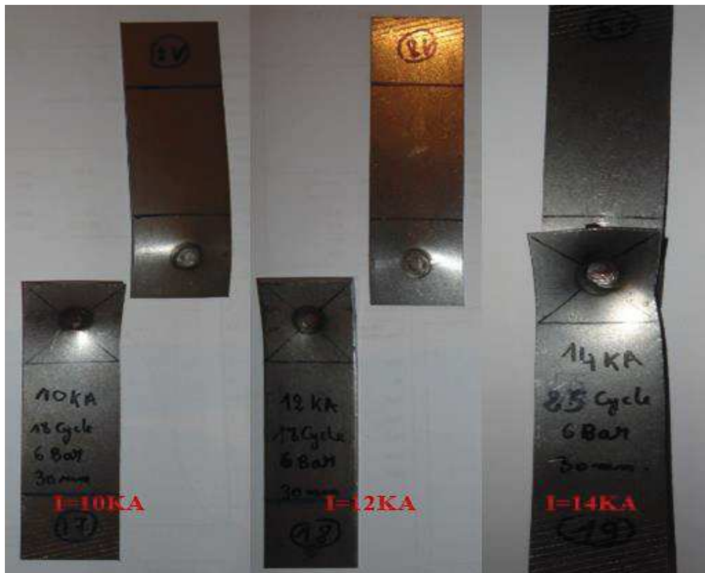
Figure III.7 : Echantillons rompus après l'essai de traction pour T=18 Cycle, A=30mm F=6 Bars, et e=2mm
