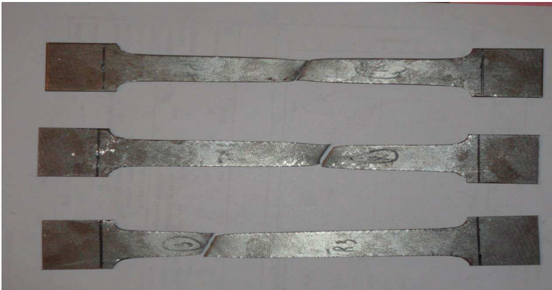
Figure II.14 : Eprouvettes rompus après essai de traction.
