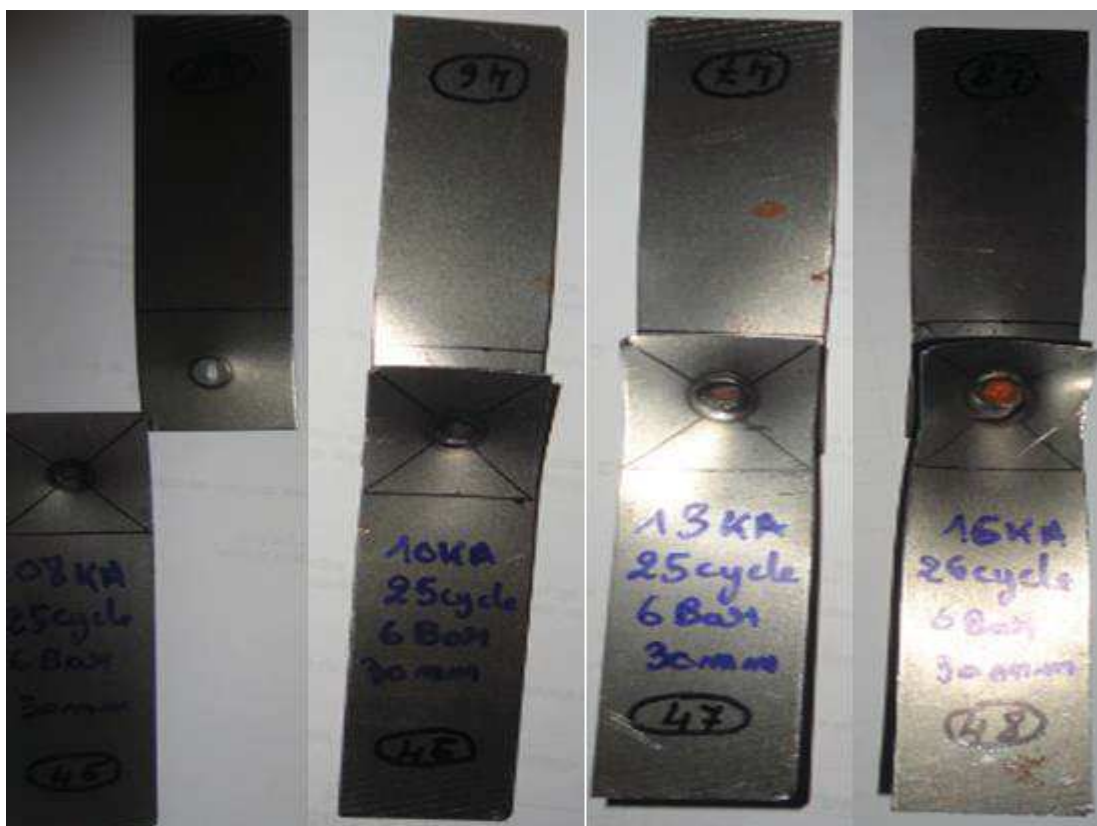
Figure III.25 : Les éprouvettes rompues après l'essai de traction pour T=25 Cycle, A=20 mm F=6 Bars et e=1 mm
