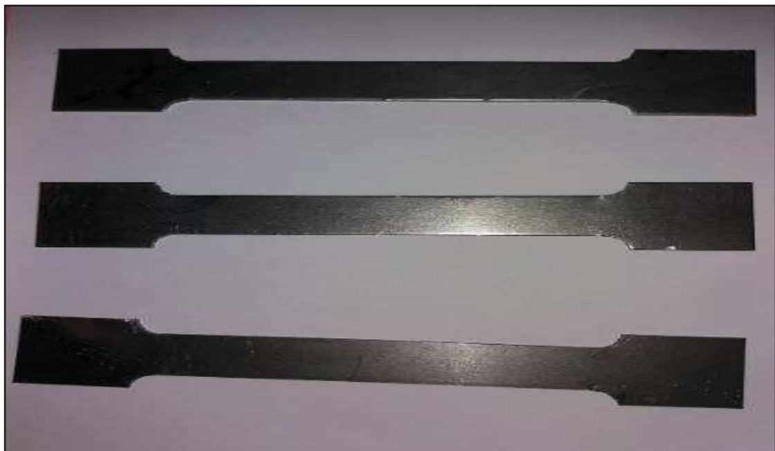
Figure II.5: Eprouvettes normalisées de traction
