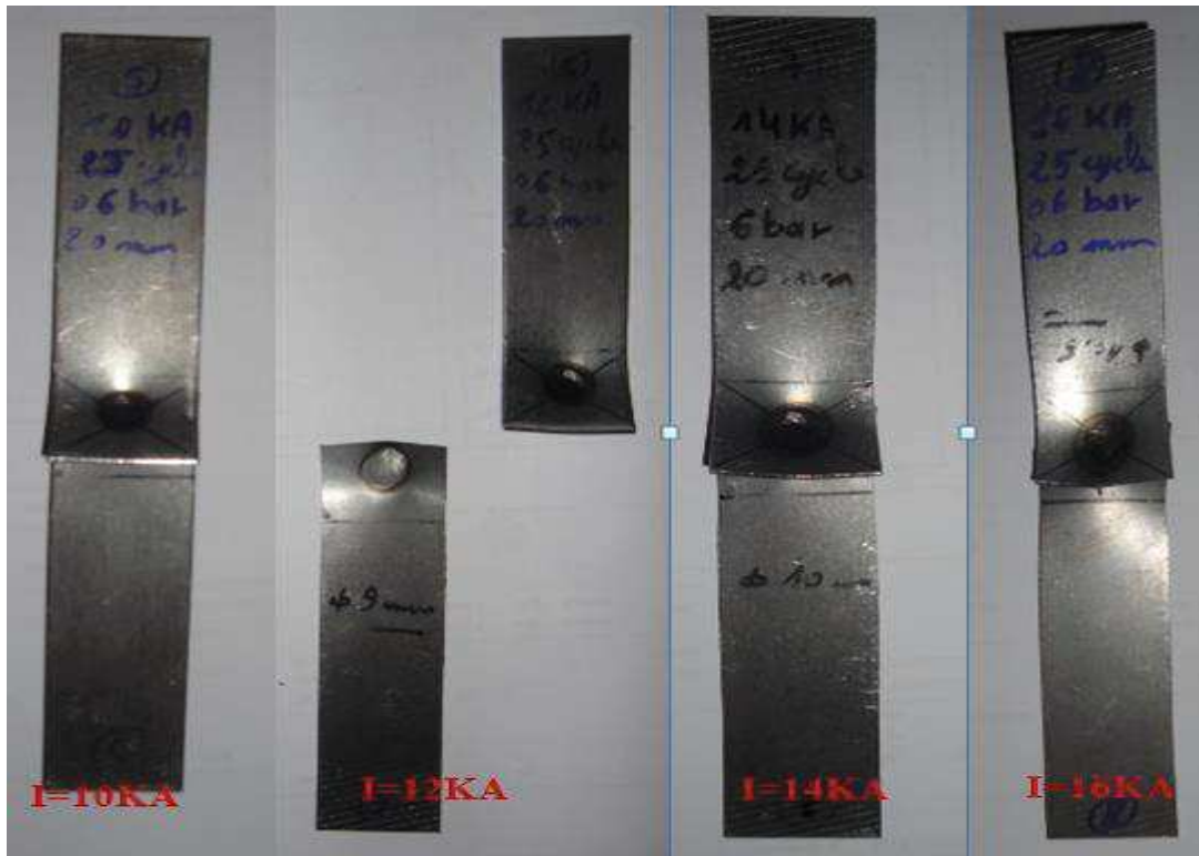
Figure III.9 : Eprouvettes rompues après l'essai de traction pour T=25 Cycle, A=20mm et F=6 Bars, et e=2mm
