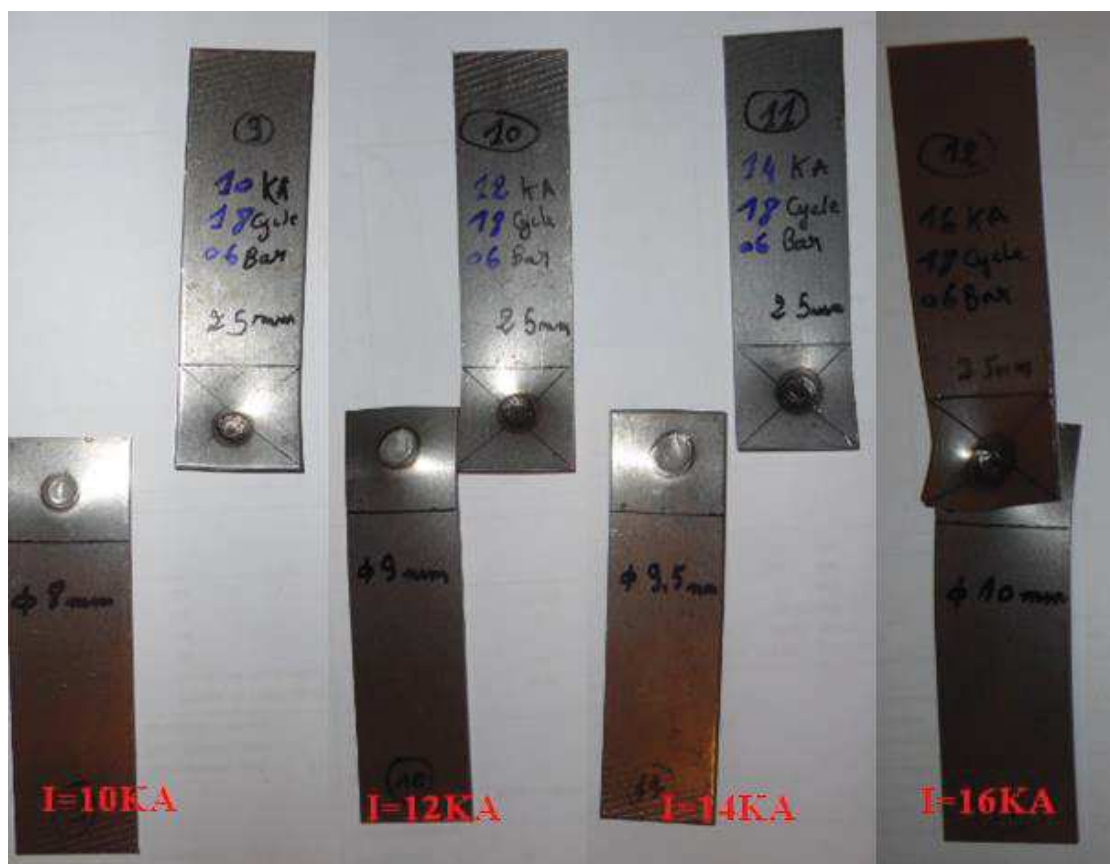
Figure III.5 : Eprouvettes rompues après l'essai de traction pour T=18 Cycle, A=25mm F=6 Bars, et e=2mm
