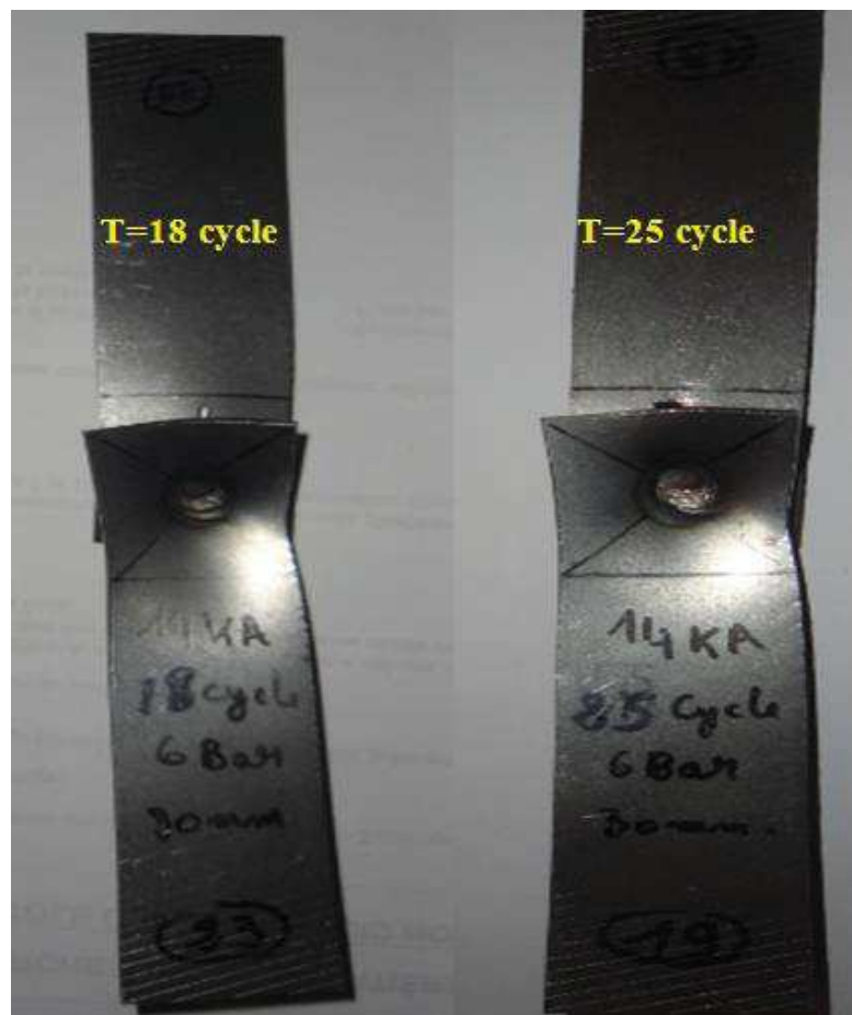
Figure III.31 : Les échantillons rompus après l'essai de traction pour I=14 KA et F=6 Bar A=30mm
