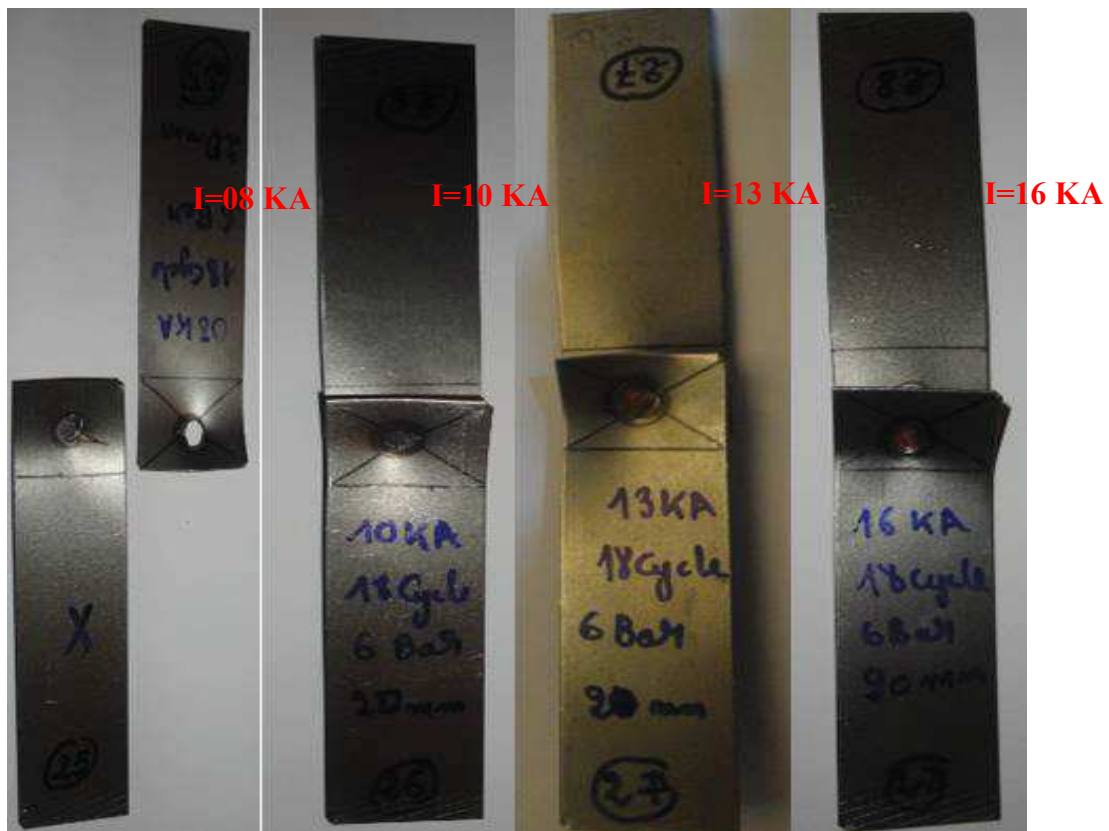
Figure III.15 : Eprouvettes rompues après l'essai de traction pour T=18 Cycle, A=20mm F=6 Bars et e=1mm
