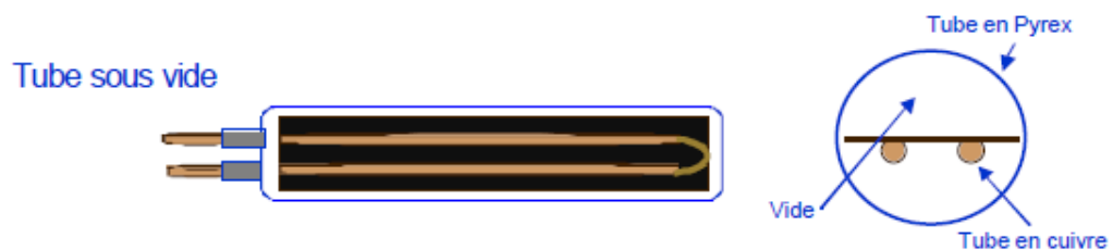
Figure IV.9 : Coupe d'un capteur sous vide [9]
