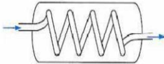
Figure I.3 : Echangeur monotube
