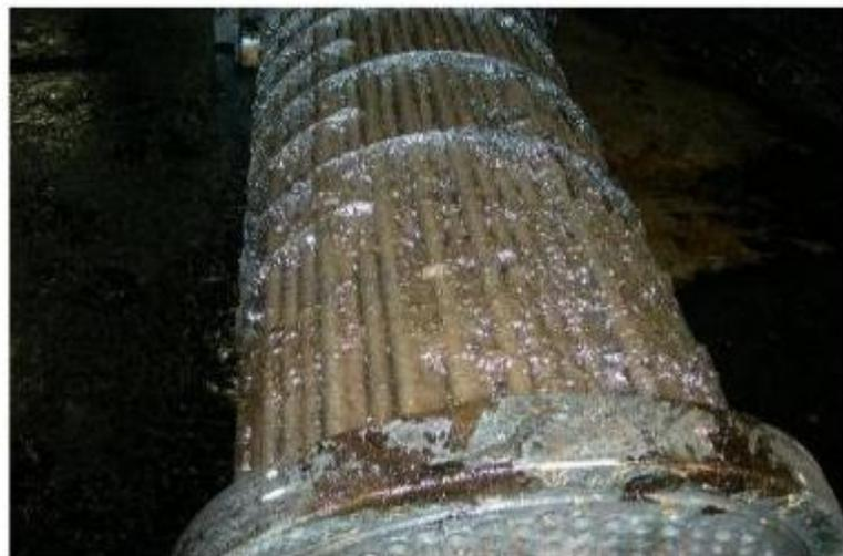
**Figure I.25.** Encrassement de l'échangeur de chaleur
