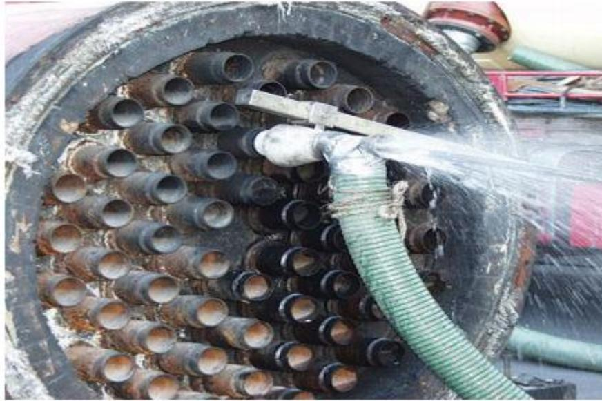
**Figure I.27 :** Nettoyage mécanique
