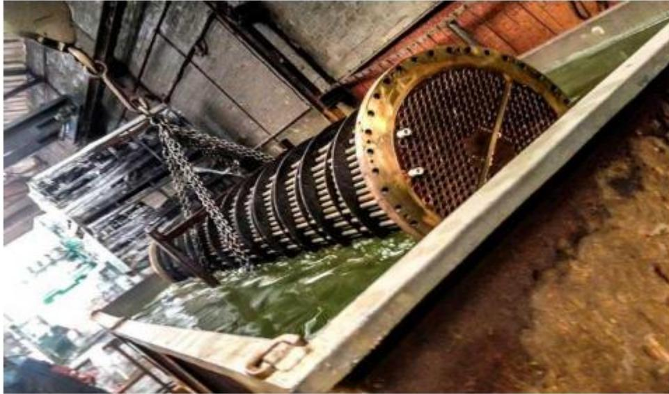
**Figure I.28** : Nettoyage chimique
