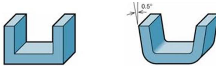
Fig. 6: Moule sans et avec dépouille[44]
