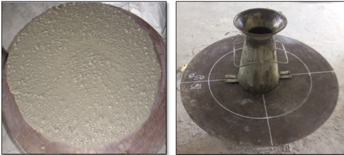
Figure IV.9. L'essai d'étalement au cône d'Abrams.
