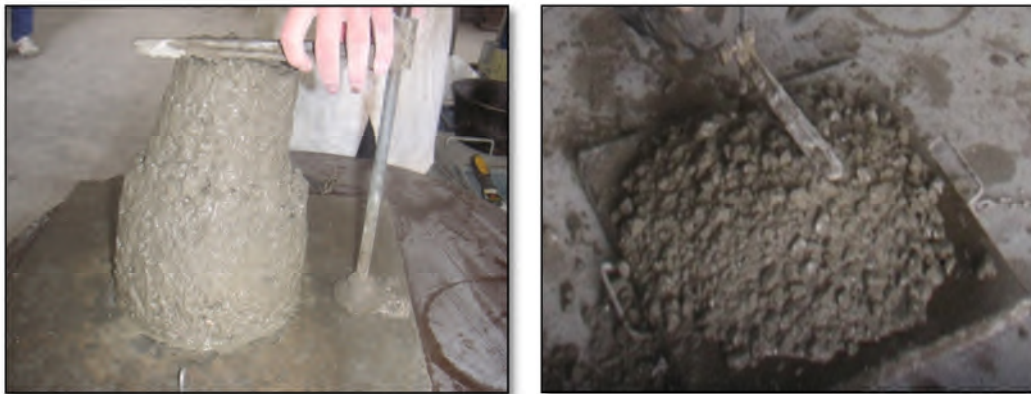
Figure IV.5. Mesure de l'affaissement du béton au cône d'Abrams.
