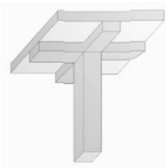
Figure 2.2 Surface supporté par le poteau le plus sollicité
