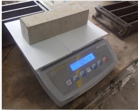
Figure 4.7. Balance électrique avec précision de l'ordre de 0.1g
