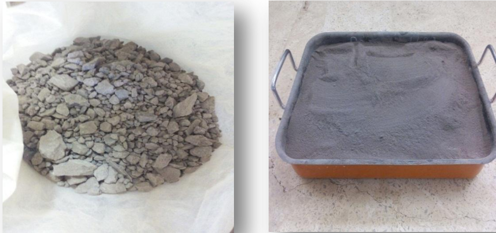
Figure 3.5. Échantillon de pouzzolane (avant et après broyage).
