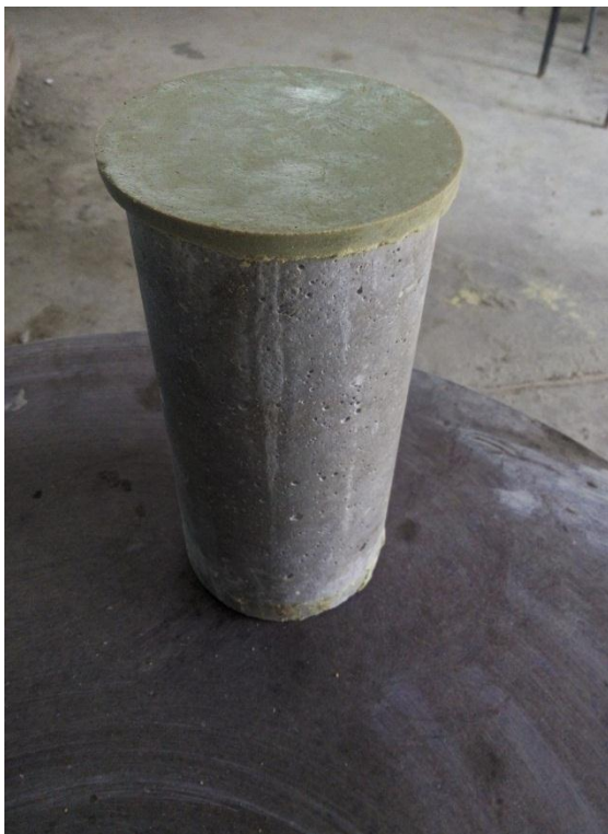
Figure 4.8. Surfaçage des éprouvettes
