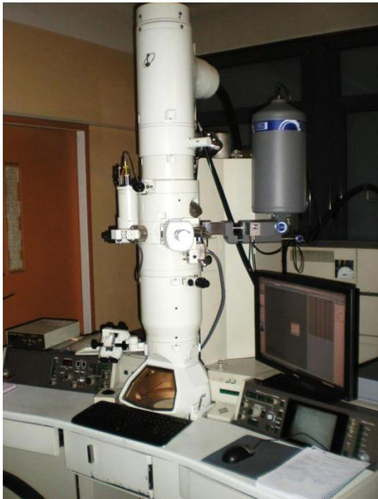
Figure 38 Microscope électronique à transmission JEOL 2012 couplé à un détecteur EDX (IRCElyon)
