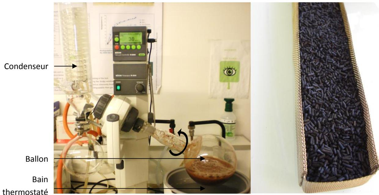
Figure 28 Dispositif expérimental d'imprégnation mis en œuvre pour imprégner le charbon actif sous vide et à température imposée (à gauche). A droite, charbons actifs imprégnés.
