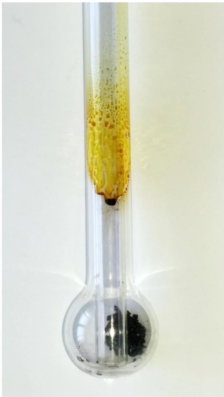
Figure 99 Désorption des espèces piégées dans le catalyseur Ce/C<sub>norit</sub> (ratio 13 : 1) après l'essai de craquage catalytique. La désorption a été effectuée à 300°C sous un vide secondaire d'environ 1 Pa.
