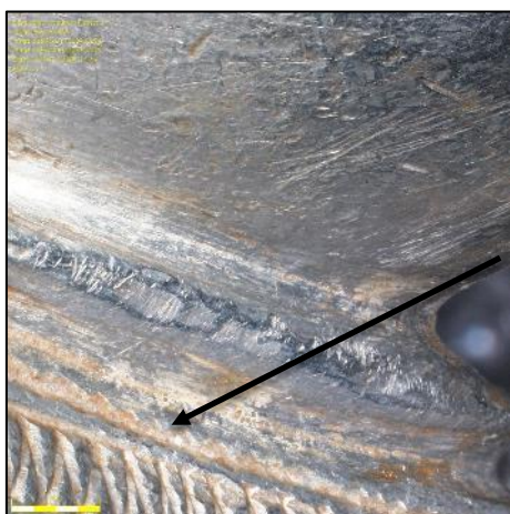
Figure 34 : Dépôt exogènes dans les interstices, objet 76.2.13a, ©C. Despland, HE-Arc
