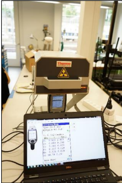
Figure 14 : Enceinte d'analyse FRX et visuel de l'exploitation par ordinateur, ©C. Despland, HE-Arc
