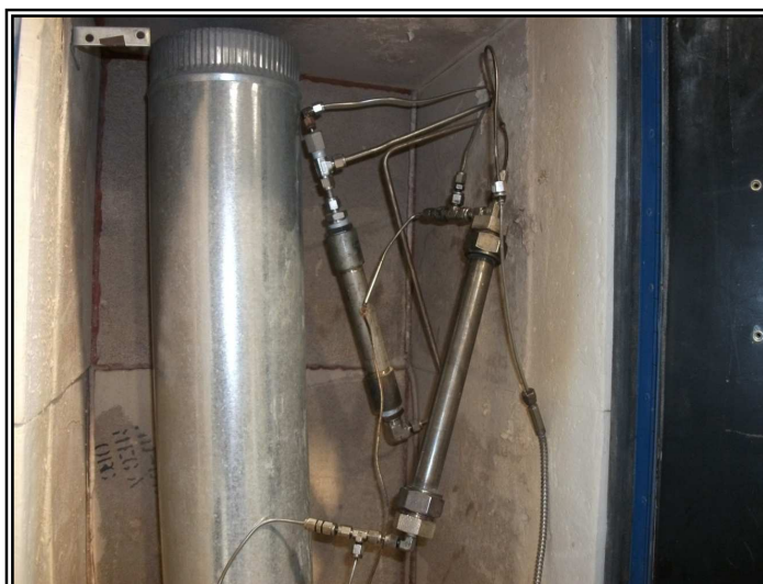
Figure 18. Intérieur du four (colonne, thermocouples et coils)
