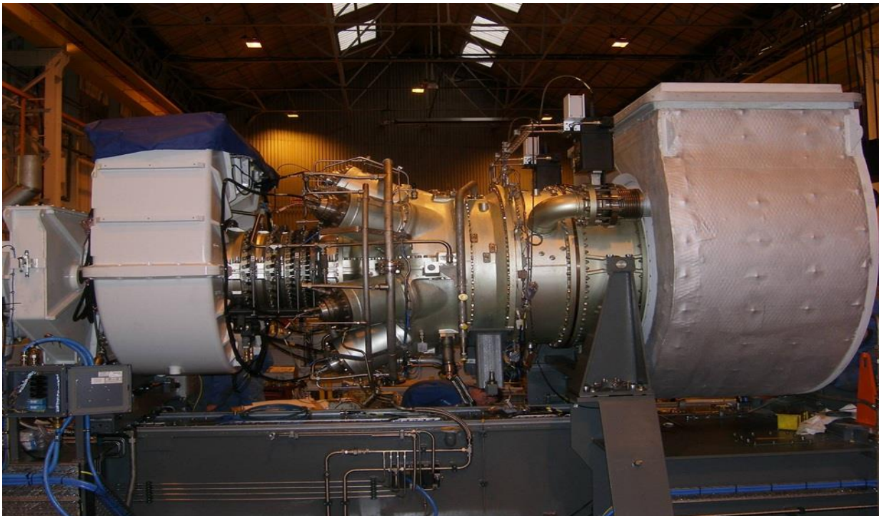
Figure III.2 : Turbine à gaz SIEMENS type SGT-400 [26]
