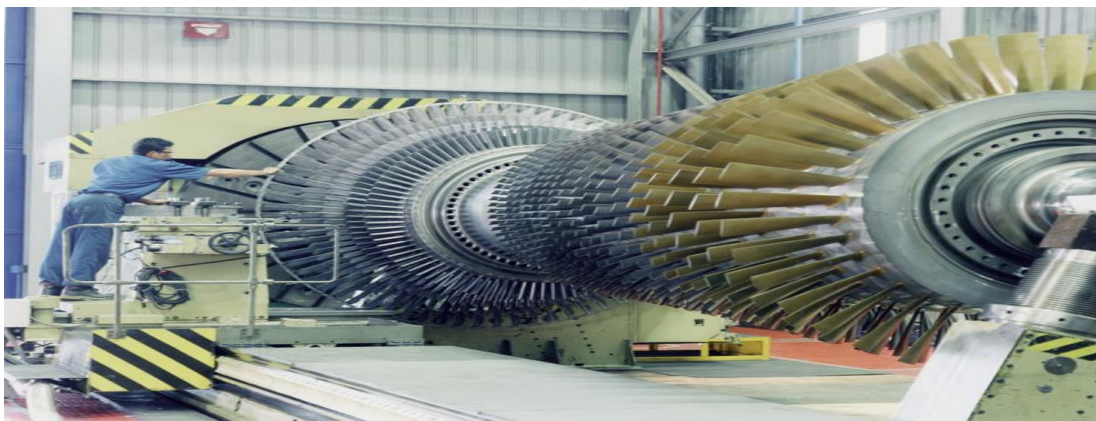
Figure II.5: Modèle d'une turbine à gaz industriel [24]
