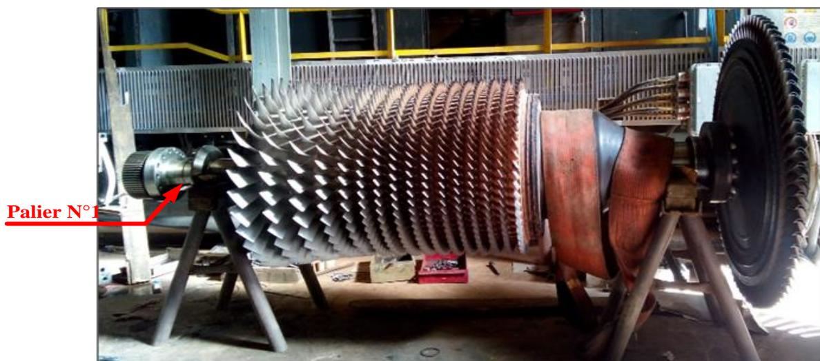
Figure (II-10) : Rotor HP (compresseur axial)
