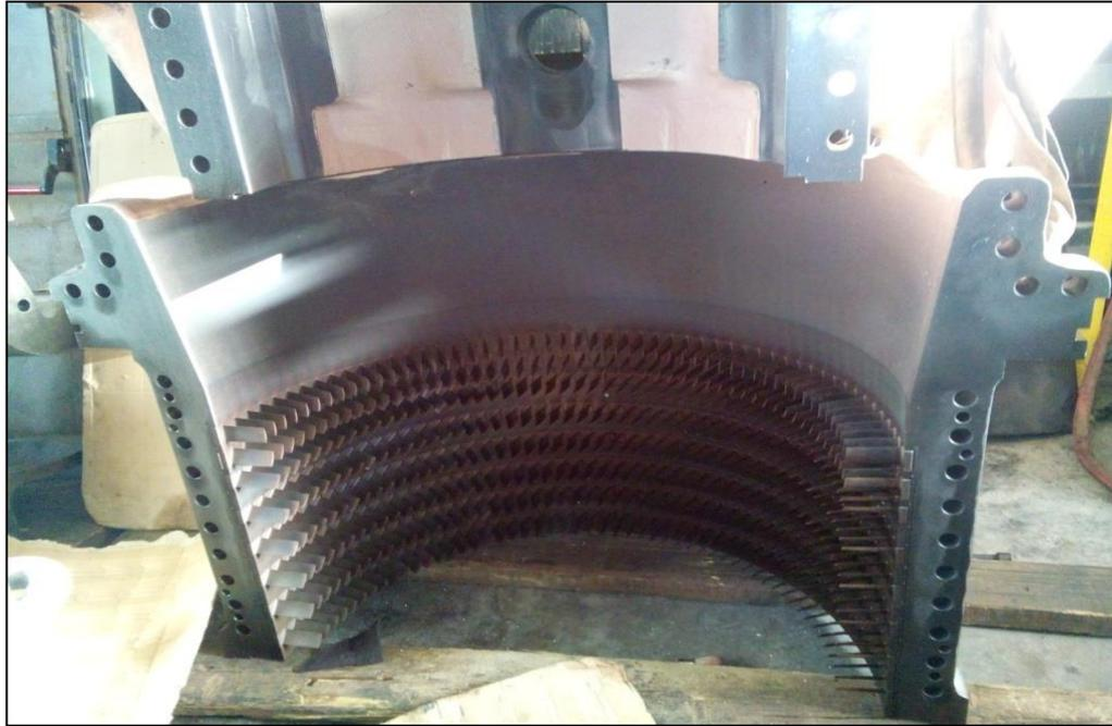
Figure (II-13) : Corps de refoulement du compresseur partie supérieure
