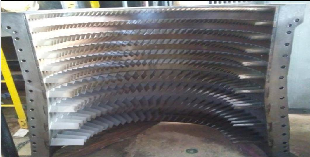
Figure (II-12) : Corps avant du compresseur partie supérieure
