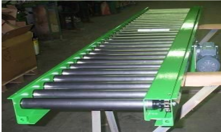
Figure I.3 : Transporteur à rouleaux [6]
