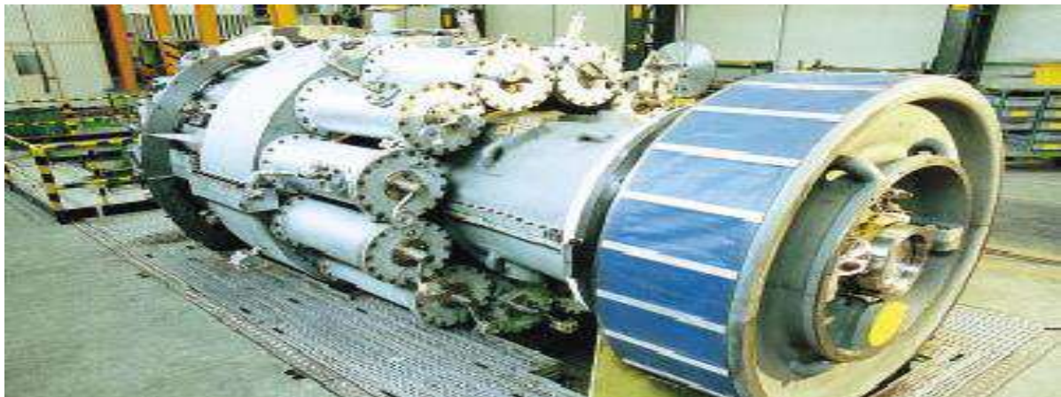
Figure (II.15) : Turbine à gaz MS 5002C.
