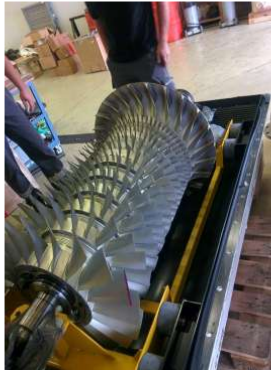
Figure (II.30) : Construction du compresseur et numérotage des étages
