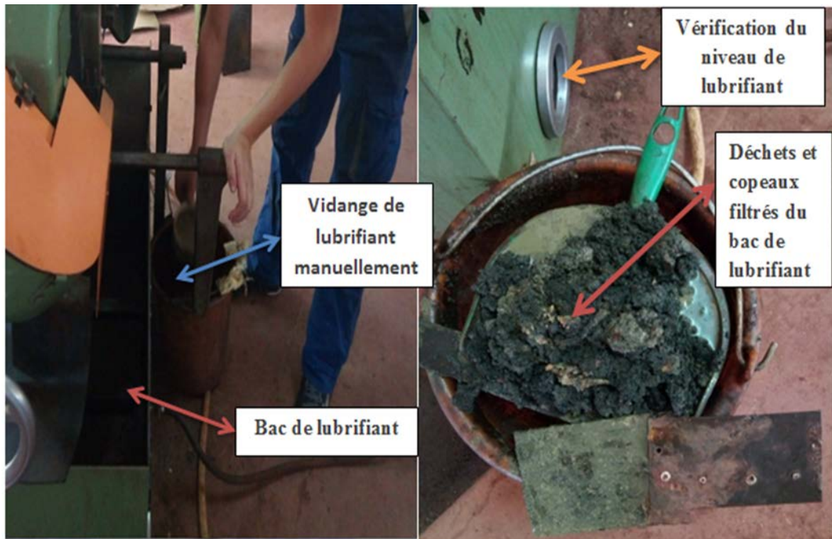
Figure IV.6 : Nettoyage et vidange manuel du bac de lubrifiant
