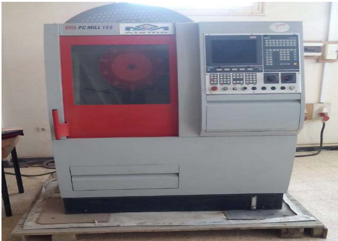
Figure I.2 Fraiseuse numérique PC MILL 155
