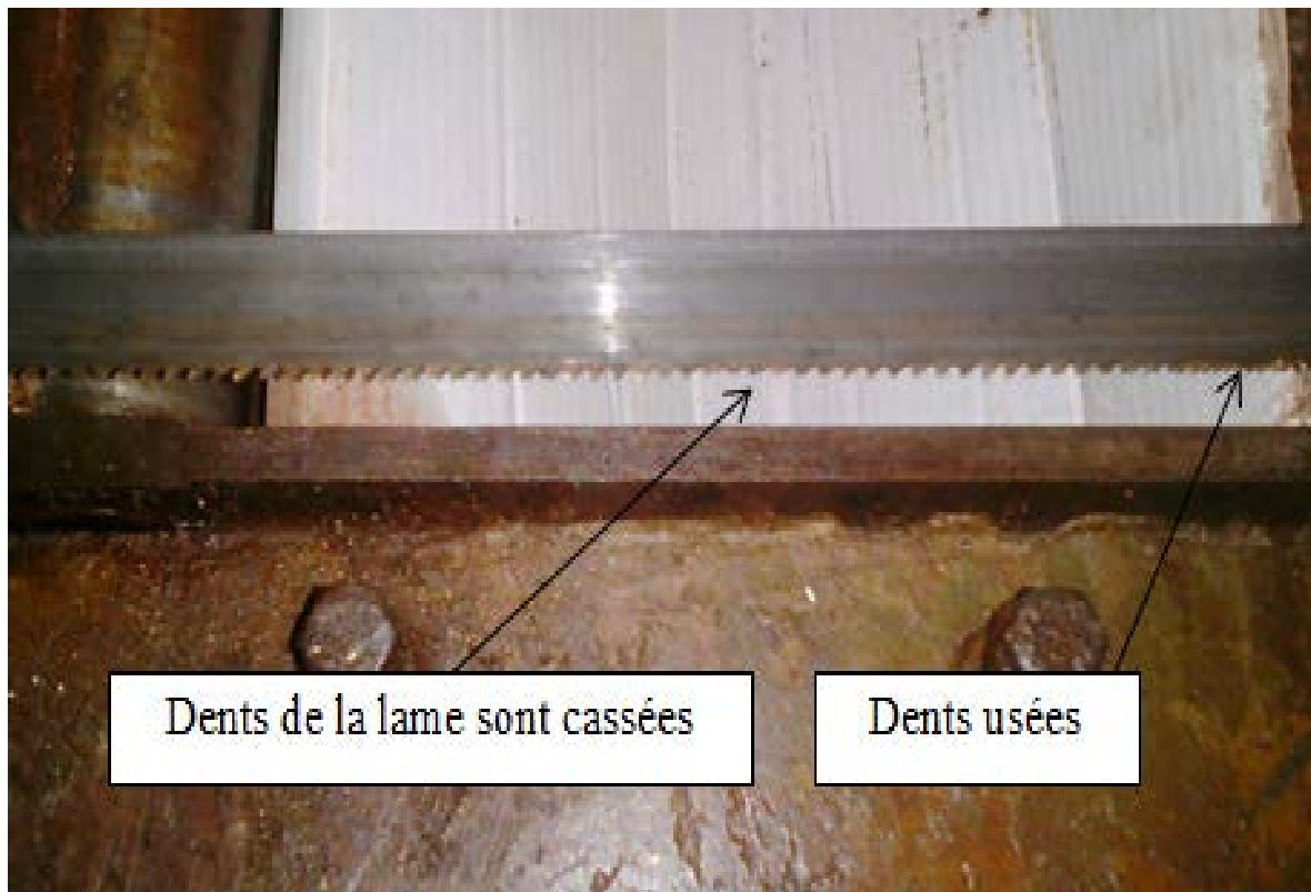
Figure III.4.6- Dents de la lame utilisée à scier.
