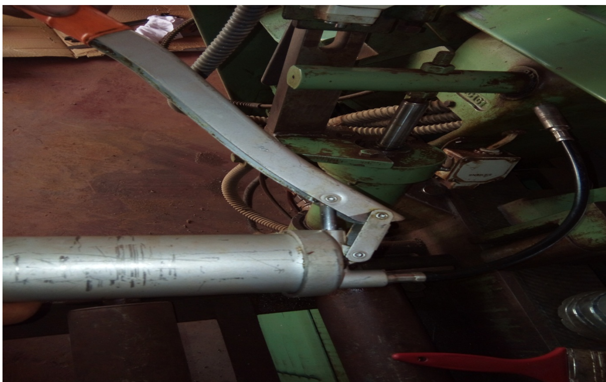
Figure IV.13 Graissage de système d'articulation de l'arceau de scie
