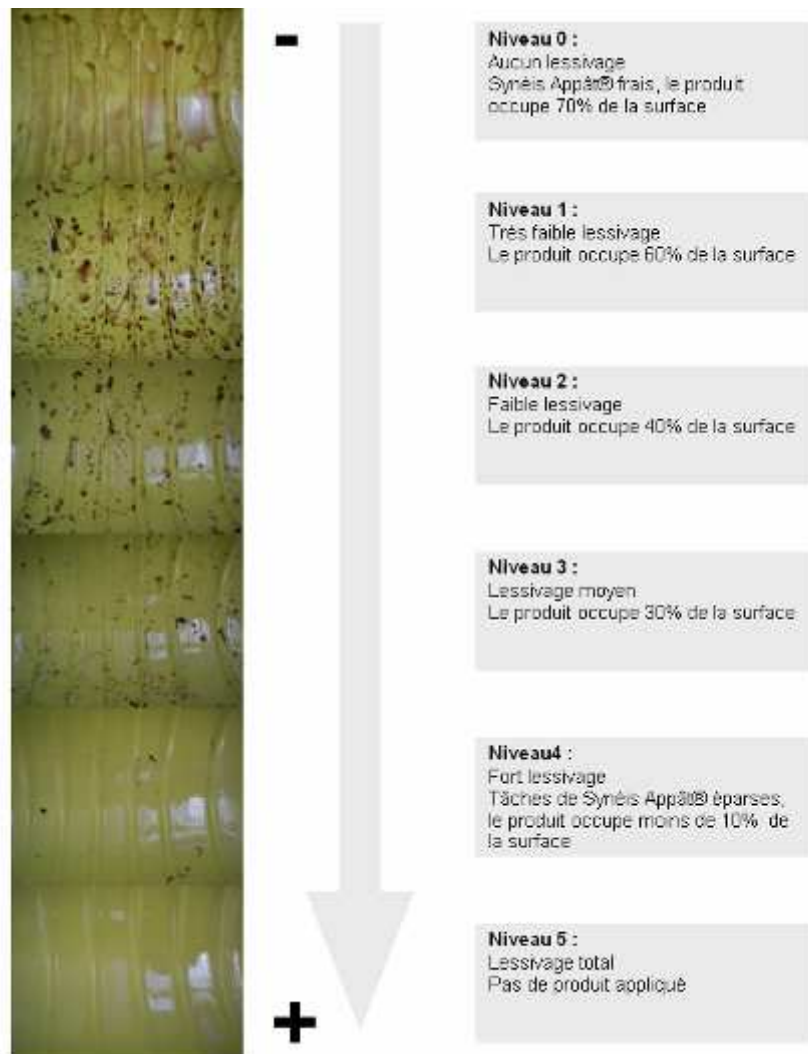
Figure 33 : Echelle de lessivage du Synéis Appât® sur DBJH. Echelle réalisée à partir de supports DBJH restés 20 jours sous treille de chouchous.
