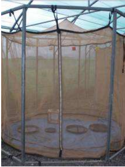
Figure 23 : Dispositif expérimental en grande cage pour tester l'effet des couleurs sur l'attractivité du dispositif
