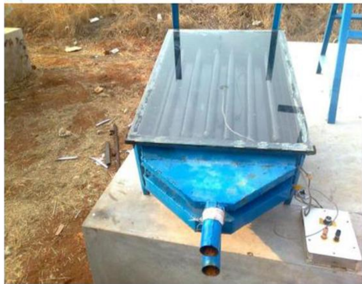
Figure I.19. Capteur à air double passe avec stockage de chaleur.
