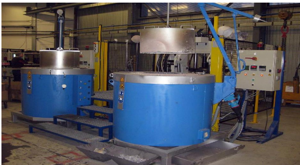
Fig.IV.3 : Four à creuset [43].
