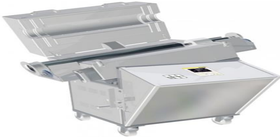
Fig.IV.5 : Exemple de four rotatif ou oscillant [44].
