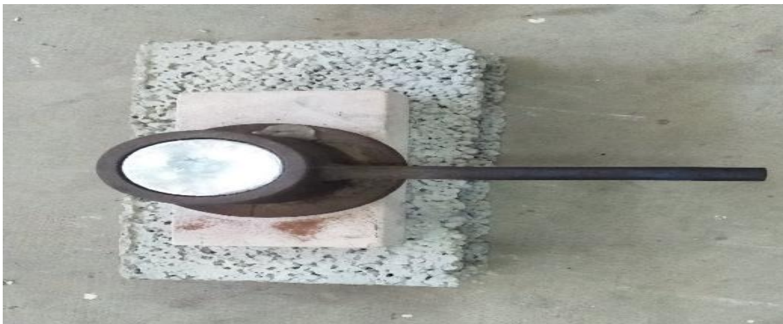
Fig.IV.14 : Refroidissement a l'air libre.
