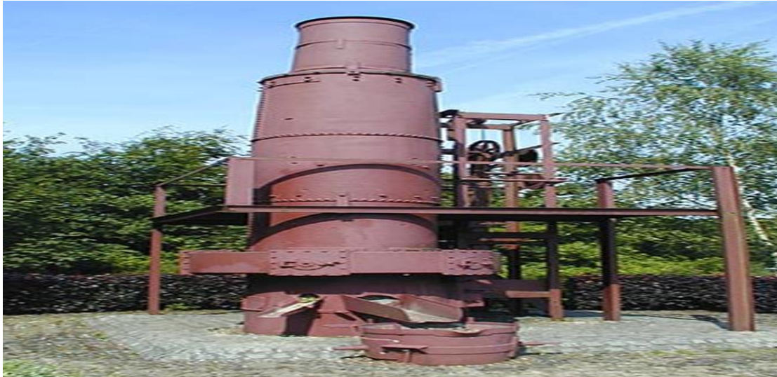
Fig.IV.2 : Four à cubilot [43].
