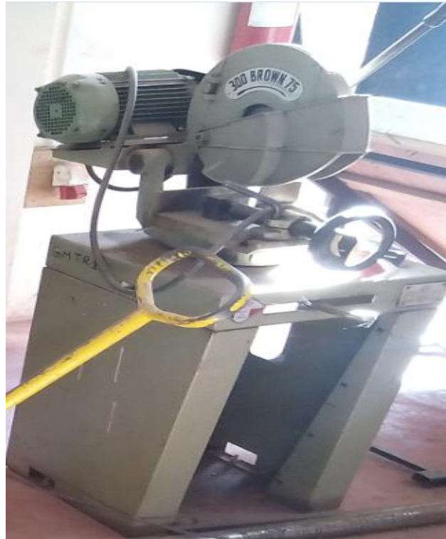
Figure I.12 tronçonneuse PEDRAZZOLI BROWN 250
