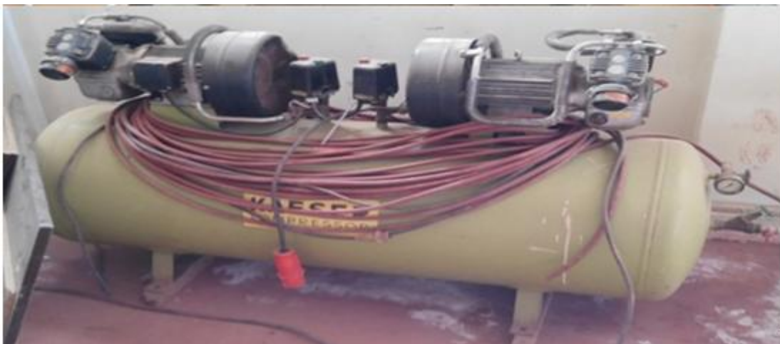
Figure 1.14a compresseur KAESER 300 litres
