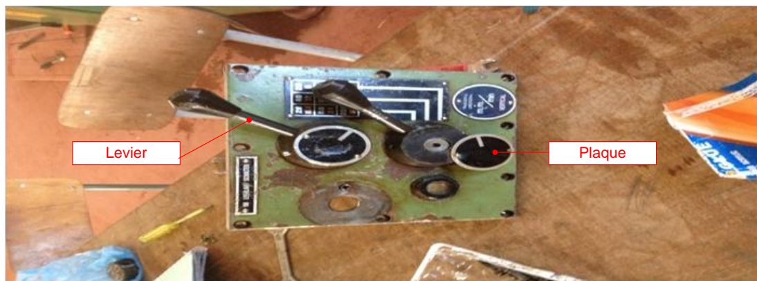
Figure III.3 manque des goupilles des leviers et plaques détachées.
