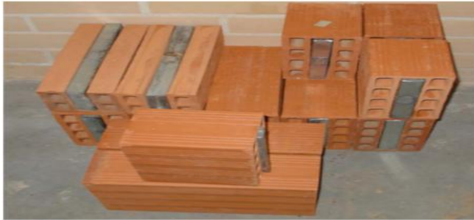
Fig. 1.26. Intégration de MCP encapsulé dans des briques [37]
