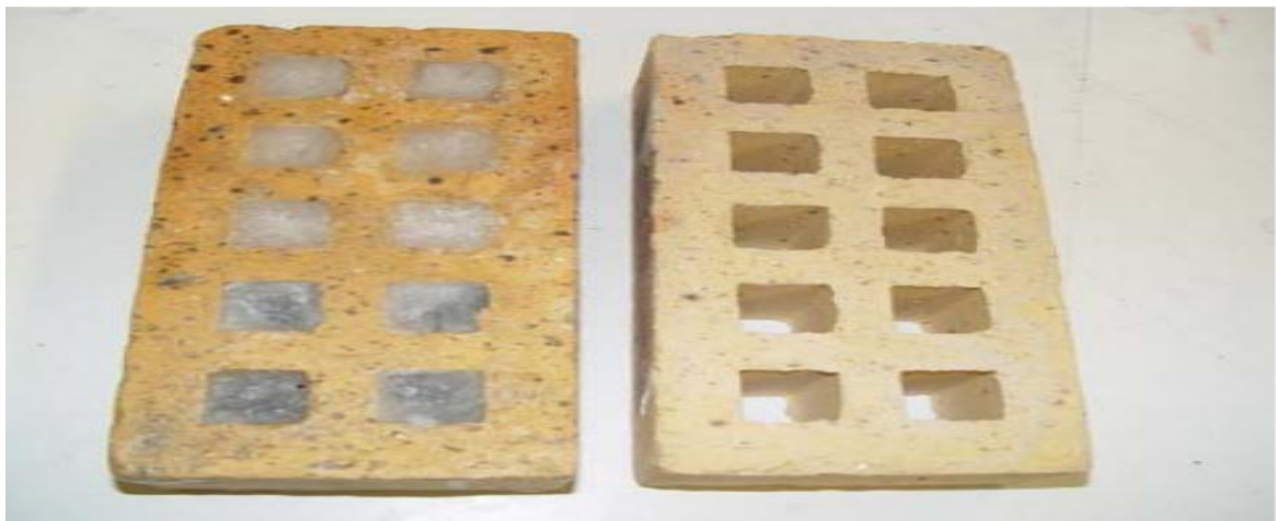
Fig. 1.28. Photographie d'une brique creuse (à droite) et de la brique remplie de paraffine (à gauche) [40]
