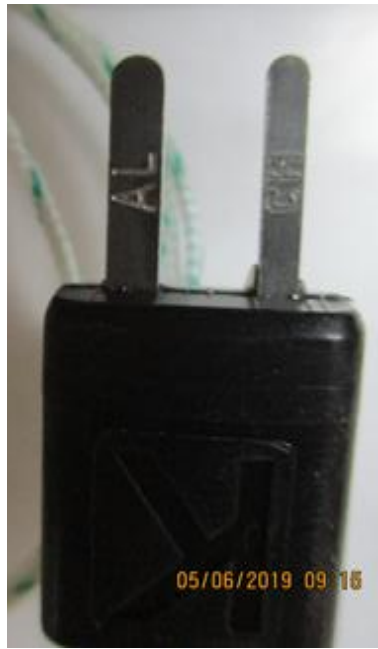
Fig. 3.9.c. Broches du capteur en cuivre Alumel
