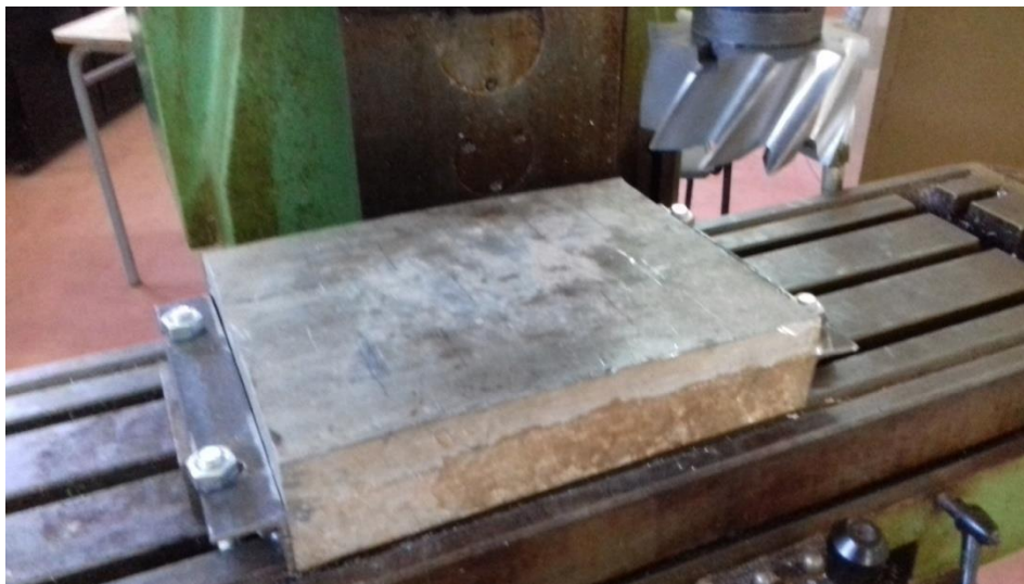
Figure 4.15 : montage du brut dans la fraiseuse
