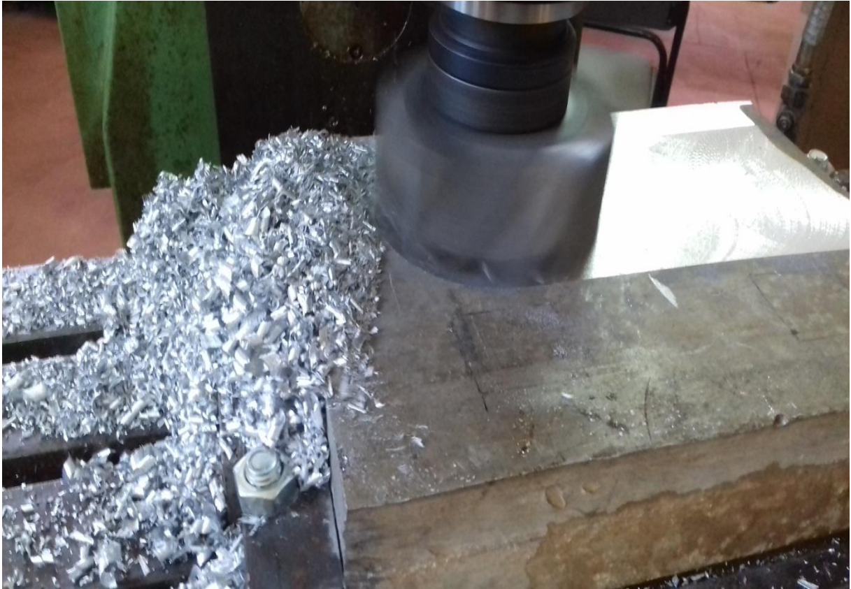
Figure 4.16 : surfaçage du brut
