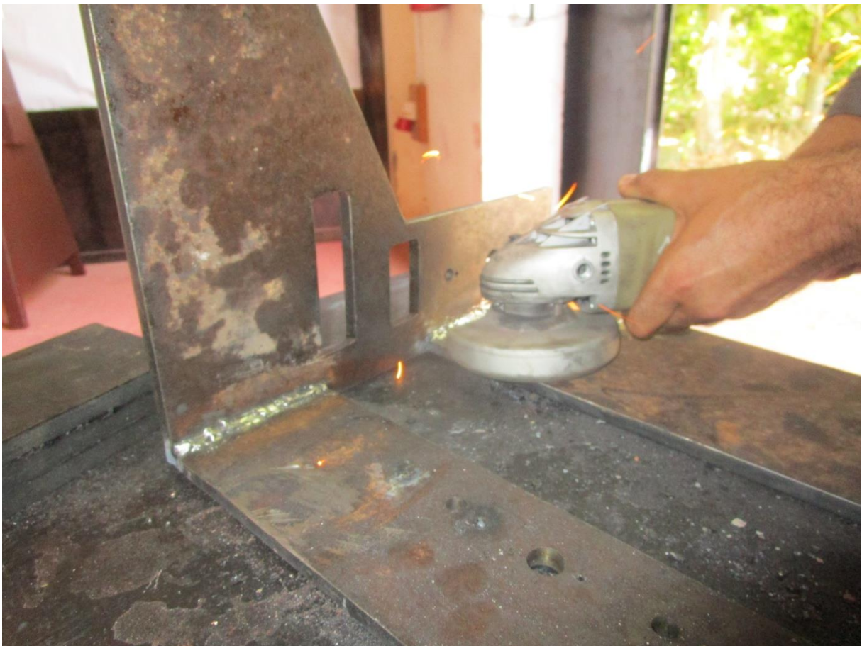
Figure 4.13 : la finition des joins de soudure
