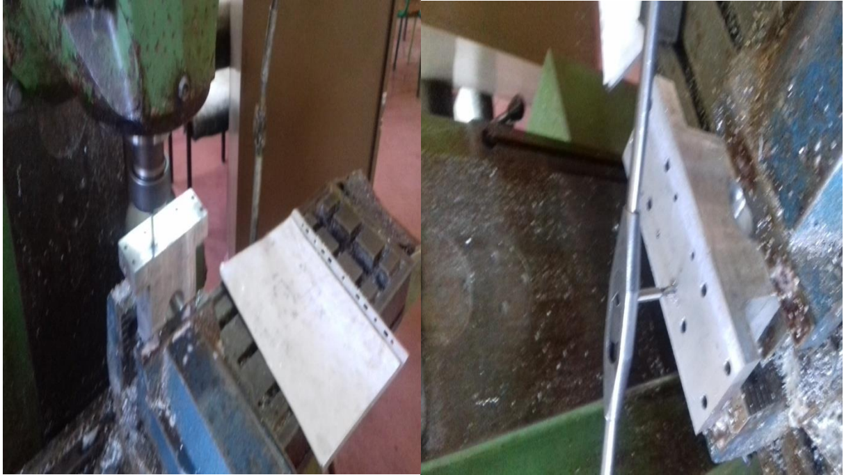
Figure 4.22 : perçage et taraudage des trous pour la fixation des paliers
