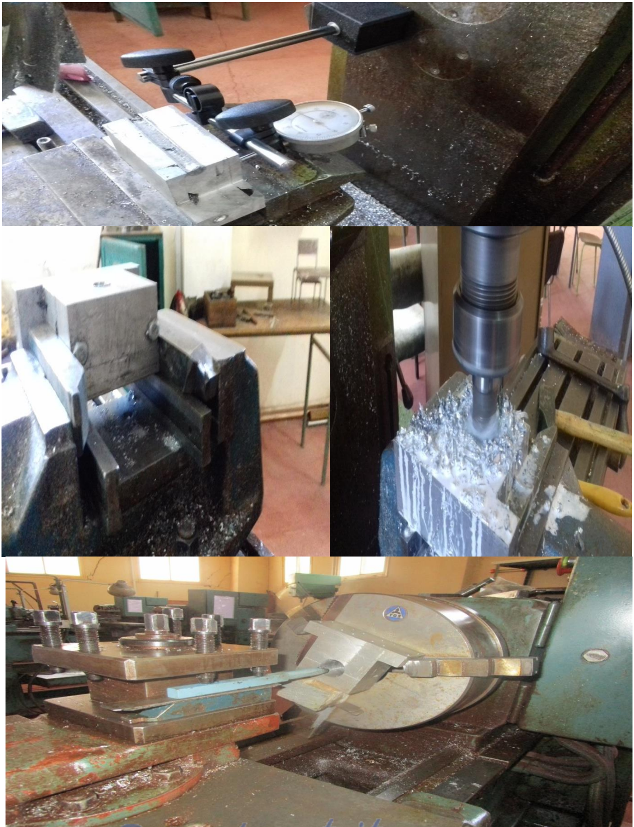
Figure 4.21 : usinage de support de la broche
