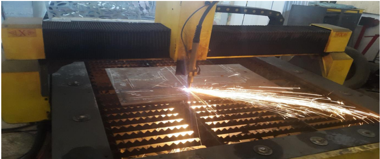
Figure 4.10 : la découpe par plasma des pièces de bâti
