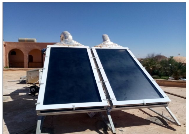
Figure III.1 prototypes de séchoir solaire de type indirect (droite) a et direct (gauche) b
