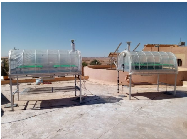
Figure III.1 prototypes de séchoir solaire de type indirect (droite) a et direct (gauche) b
