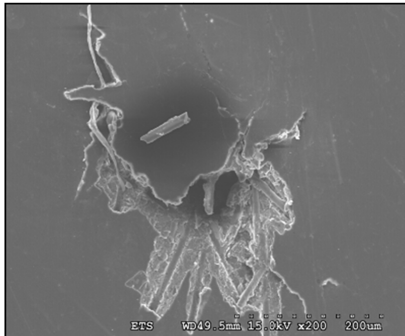
Figure 5.8 Trace de claquage sous forme de trou
