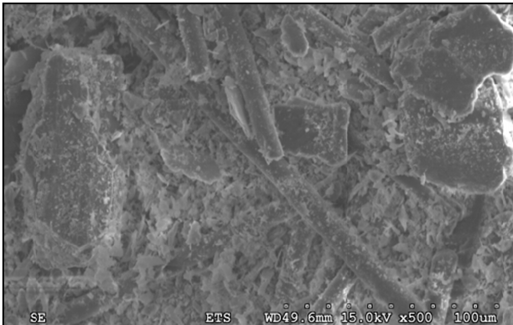
Figure 5.11 Érosion à haute température
