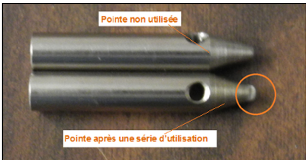
Figure 3.13 Pointe avant et après une série d'utilisation
