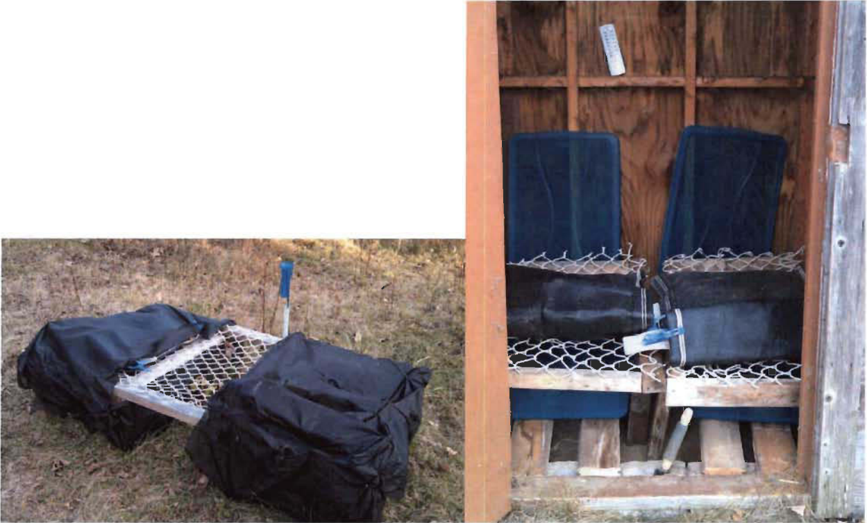
Figure 4 Montage de l'expérience de l'entreposage en contenant étanche (L1 : étang 4, L3 : étang 1) des biosolides de la station d'épuration de Louiseville soumis aux précipitations. Site d'entreposage à St-Boniface. Montage de l'expérience de l'entreposage en contenant étanche (L2 : étang 4, L4 : étang 1) des biosolides de la station d'épuration de Louiseville non soumis aux précipitations. Site d'entreposage à St-Boniface
