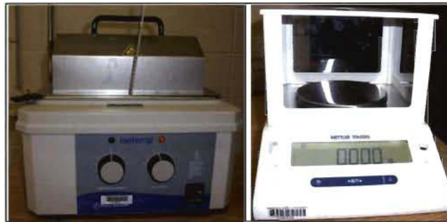
Figure II. 8 Bain isothermique (Isotemp) et balance de précision de 10^{-3} g (Mettler Toledo).
