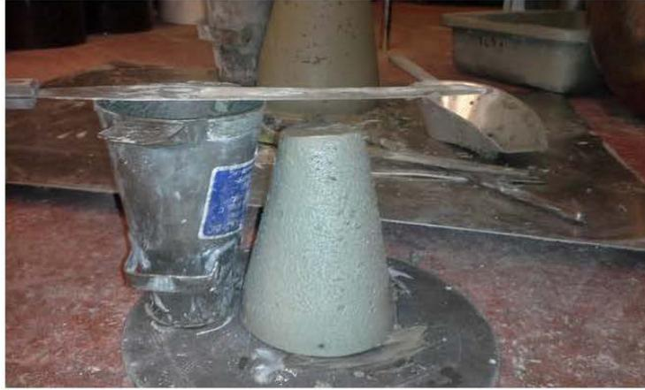
Figure 2.5 : Essai d'affaissement au petit cône d'Abrams
