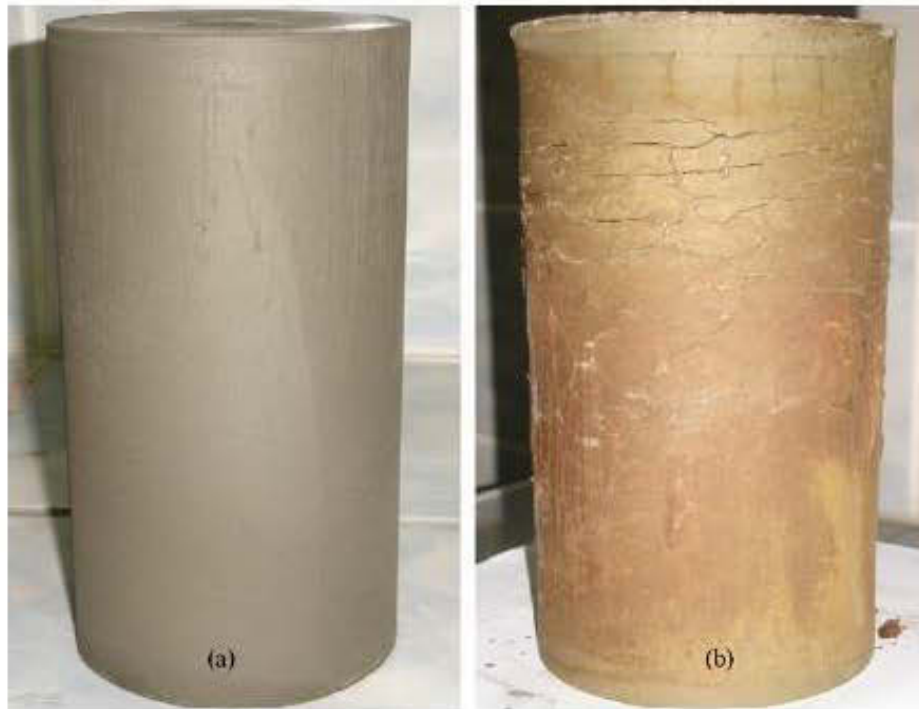
Figure 2.13 : Visualisation de l'attaque sulfatique interne sur des échantillons de RPC (Ercikdi et al., 2009)
